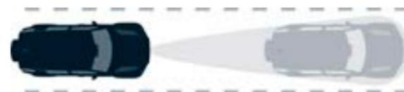
El **control de crucero adaptativo** facilita situaciones de conducción en carretera y de mucho tráfico. El sistema logra esto gracias a la asistencia sutil con la aceleración y el frenado para mantener una distancia fija en relación con los vehículos que están delante.
