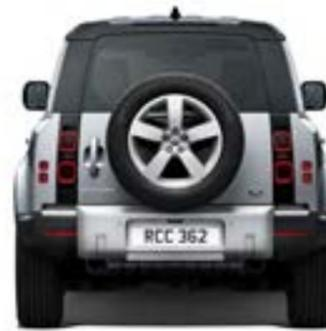
Distancia entre las ruedas traseras con suspensión neumática 1.706 mm††
