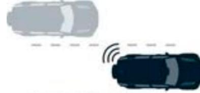
La **asistencia en ángulo muerto** te ayuda a cambiar de carril de manera más segura mediante la iluminación de una pequeña luz de advertencia en el espejo lateral si tu vehículo detecta otro vehículo en tu punto ciego. La corrección adicional de la dirección te ayudará a orientar el vehículo en caso de que se detecte una posible colisión.
